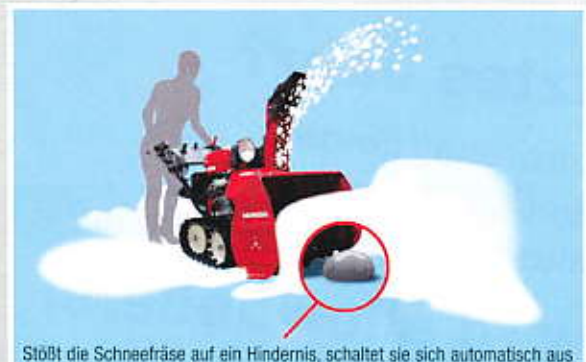
Stößt die Schneefräse auf ein Hindernis, schaltet sie sich automatisch aus.
